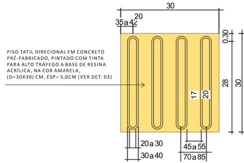
PISO TÁTIL DIRECIONAL EM CONCRETO PRÉ-FABRICADO, PINTADO COM TINTA PARA ALTO TRÁFEGO A BASE DE RESINA ACRÍLICA, NA COR AMARELA, (D=30x30) CM, ESP= 5,0CM (VER DET. 03)
