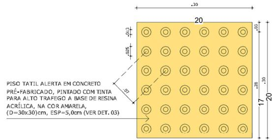
PISO TÁTIL ALERTA EM CONCRETO PRÉ-FABRICADO, PINTADO COM TINTA PARA ALTO TRÁFEGO A BASE DE RESINA ACRÍLICA, NA COR AMARELA, (D=30x30) CM, ESP= 5,0CM (VER DET. 03)
