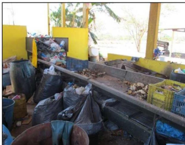
Foto Exemplo de Centro de Triagem e Compostagem - Esteira para segregação dos Resíduos Sólidos.
