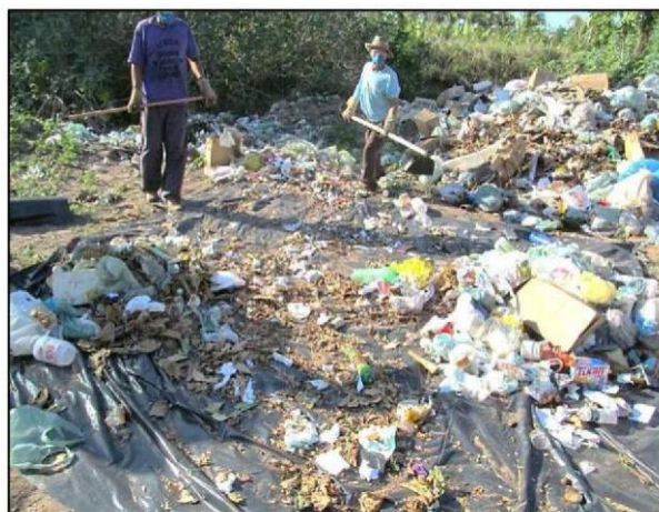
Foto : Homogeneização dos resíduos sólidos no procedimento de caracterização física.
